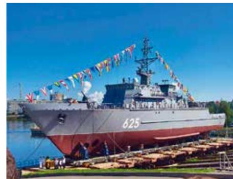
Проект 12700 разработан Центральным морским конструкторским бюро ОСК «Алмаз» для ВМФ РФ. Эти корабли относятся к новому поколению минно-тральных сил и предназначены для борьбы с морскими минами, которые новые корабли противоминной обороны могут обнаруживать как в морской воде, так и в морском грунте, не входя в опасную зону. Для борьбы с минами корабли могут применять различные виды тралов, а также телеуправляемые и автономные необитаемые подводные аппараты.
