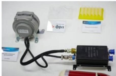
Среди преимуществ синхронного двигателя перед асинхронным – большой коэффициент мощности и полезного действия, более широкий диапазон регулировки частоты вращения, высокая надежность эксплуатации, лучшие массогабаритные показатели. Его высокая перегрузочная способность позволяет удерживать постоянную частоту
