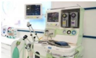
Преимущества МАИА-01 – в наличии режима принудительной вентиляции легких с двойным контролем, который позволяет одновременно регулировать давление и объем доставляемой пациенту смеси. Такой способ обеспечивает большую безопасность в сравнении с традиционными режимами ИВЛ.
