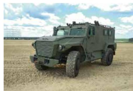
Броневедомоциклы семейства «Атлет» в базовой комплектации имеют противопульную стойкость по 3-му классу по ОТГ (соответствует второму уровню по STANAG 4569) и обеспечивают противоминную стойкость при подрыве мины или взрывного устройства мощностью до 2 кг в тротиловом эквиваленте под колесом или под днищем.
