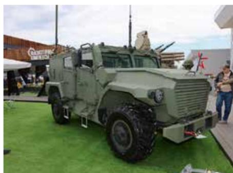
Основными отличиями броневедомоцикла «Атлет-Э» от броневедомоциклов «Атлет», созданных по заказу МО РФ, являются: измененный пятидверный бронированный корпус, импортный дизель Cummins ISB6.7E5300 мощностью 292 л.с. с экологическим классом Евро-5 либо многотопливный дизельный двигатель российского производства увеличенной мощности; импортная автоматическая коробка переключения передач.
