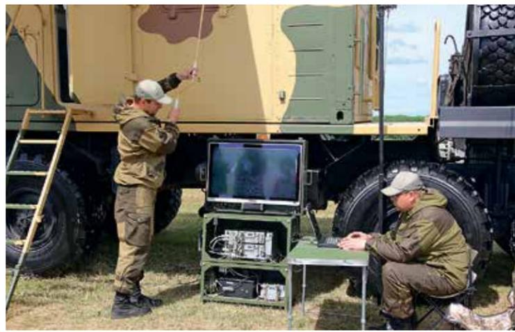
УМТК «Адъютант» предельно прост и безопасен в применении. В составе изделий нет взрывоопасных компонентов — запуск осуществляется катапультным способом. Развертывание занимает максимум два часа (заводская команда выполняет данную работу за 20 минут). Управление комплексом осуществляется в радиусе 40 км с мобильного наземного пункта. В радиусе управления коррективы в полет мишени —
