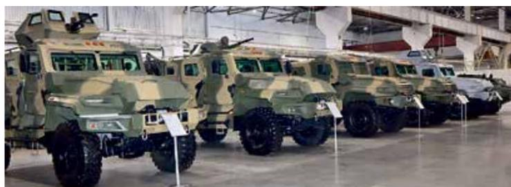
Баллистическая защита «держит» бронебойную пулю Б-32 калибра 7,62x54 мм. Противоминная стойкость броневых автомобилей семейства «Спартак» обеспечивает защиту экипажа от подрыва взрывных устройств мощностью 6 кг в тротиловом эквиваленте под колесом или днищем, а на некоторых модификациях — до 8 кг.
