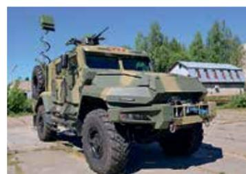
Учитывая серьезную угрозу, исходящую от массового применения дронов-камикадзе, конструкторами на базе шасси броневых автомобилей «Спартак» был создан многофункциональный мобильный комплекс обнаружения, подавления и уничтожения малоразмерных БПЛА «Спартак — Рапира-БПЛА». В состав комплекса входят РЛС с дальностью обнаружения малогабаритных БПЛА до 5 км, комплекс подавления каналов управления и навигации БПЛА и дистанционно управляемый боевой модуль «Арбалет ДМ» с 12,7 и 7,62-мм пулеметами.
