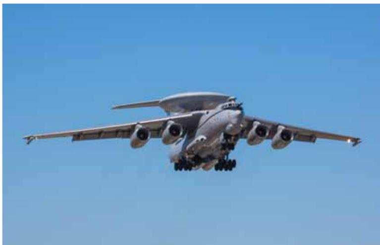
Авиационный комплекс нового поколения создан на базе самолета Ил-76МД-90А, на котором установлены разработанные Концерном «Вега» (входит в «Росэлектронику») обтекатель с уникальной антенной системой и новейшее специальное радиотехническое оборудование. А-100 может обнаруживать и сопровождать воздушные и иные цели, а также участвовать в управлении истребительной и ударной авиацией при наведении на воздушные, наземные и морские цели.
